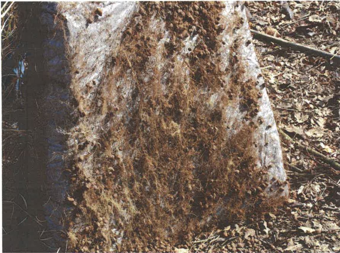
Abb. 3: Gut durchwurzeltes Schutz- bzw. Trennvlies (200 g/m 2 ) der Kontrolle
